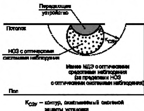
Рисунок 4 — Передающее устройство лазера класса 1М или 2М вблизи края крыши в неограниченной зоне
