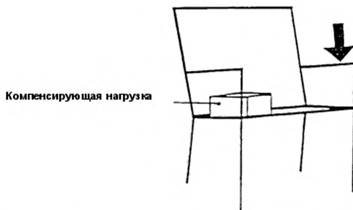
Рисунок 12 — Испытание подлокотника под действием направленной вниз статической нагрузки
