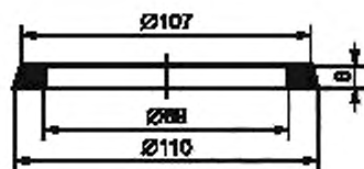
Рисунок 13 — Прокладка s6 диаметром 110/89
