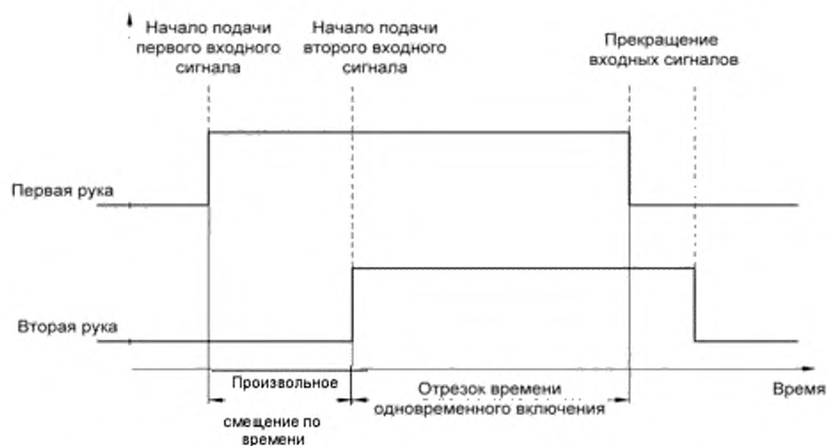
Рисунок 2 – Входные сигналы при одновременном включении
