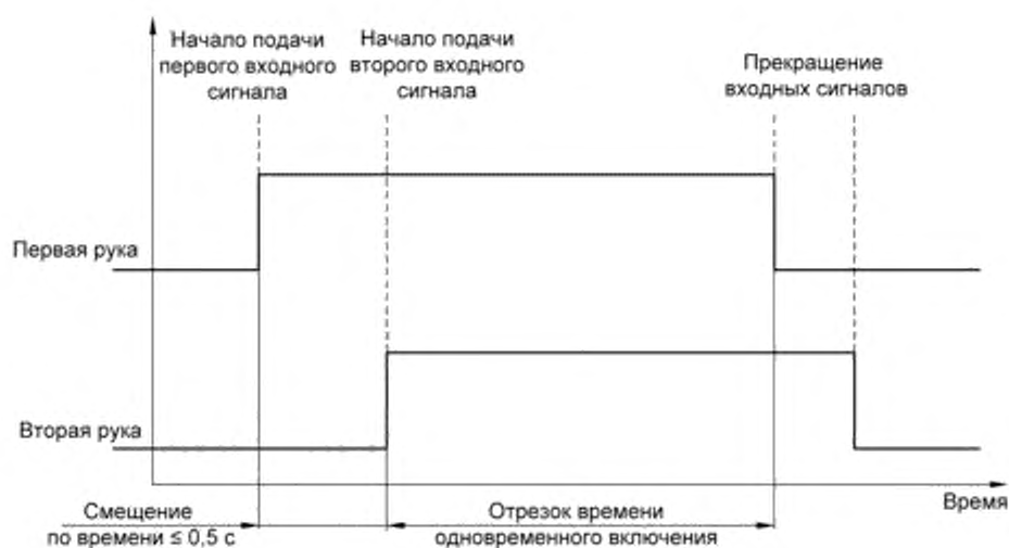
Рисунок 3 – Входные сигналы при синхронном включении
