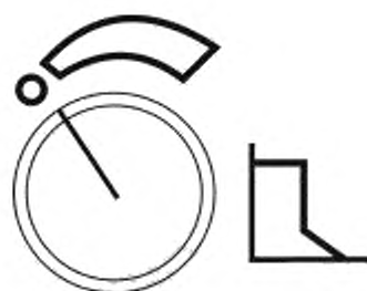
Рисунок L.2 — Потенциометр для регулировки мощности дуги
