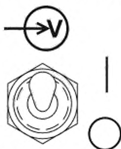
Рисунок L.1 — Силовой переключатель входного напряжения
