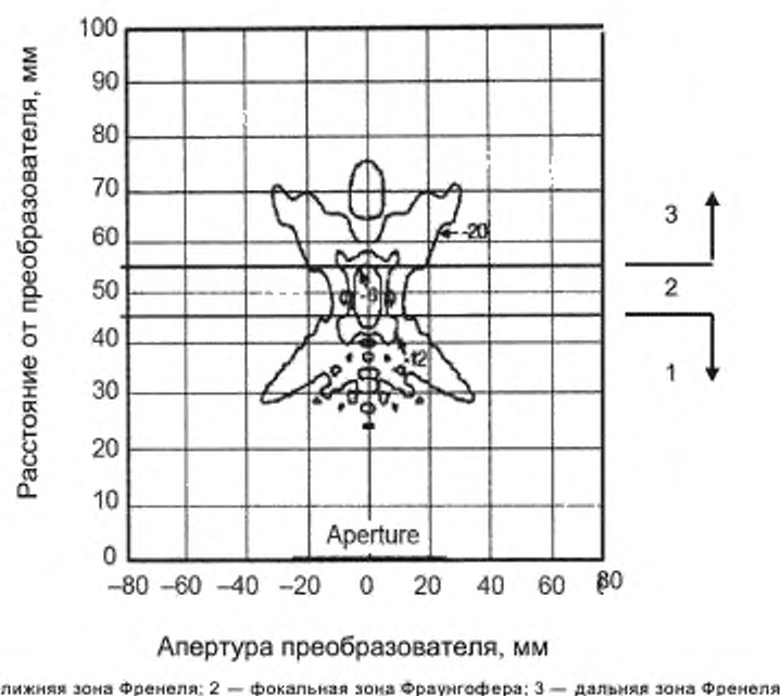
Рисунок 4 — Профиль пучка, ограниченный контурами на уровне минус 6 дБ, минус 12 дБ и минус 20 дБ, для преобразователя радиусом 12 мм с кривизной радиусом 50 мм на частоте 5 МГц, центр которого расположен в точке (0; 0)
