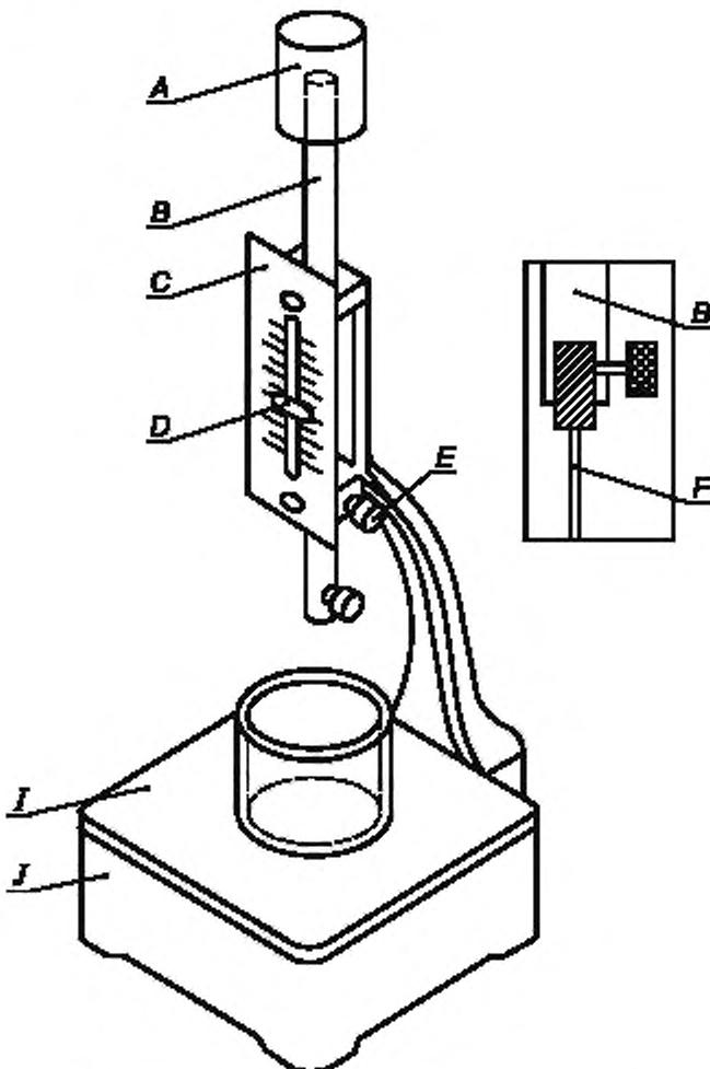
*A* — дополнительная нагрузка, *B* — стержень длиной  $(270 \pm 5)$  мм и диаметром  $(10 \pm 1)$  мм; *C* — измерительная шкала, мм;
