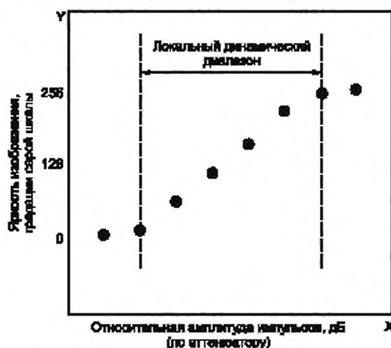
Рисунок 5 — Значения яркости оцифрованного изображения в зависимости от параметров аттенюатора при измерении локального динамического диапазона с помощью внешнего акустического сигнала
