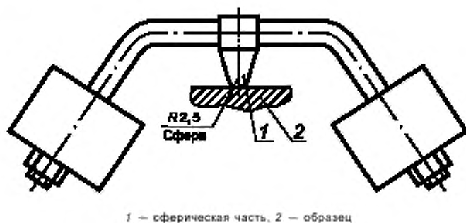
Рисунок 6 — Устройство для вдавливания шарика
