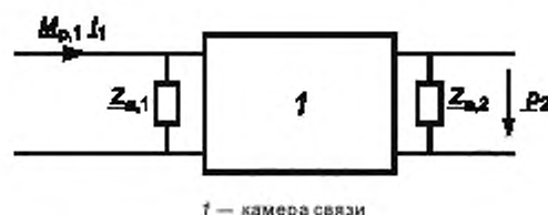
Рисунок 1 — Эквивалентная схема для определения акустического передаточного импеданса Z_{a,12}
