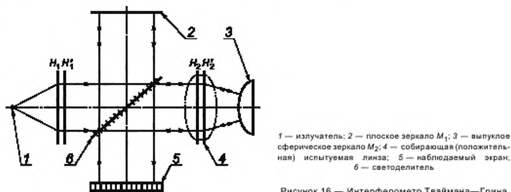
Рисунок 16 — Интерферометр Тваймана—Грина
