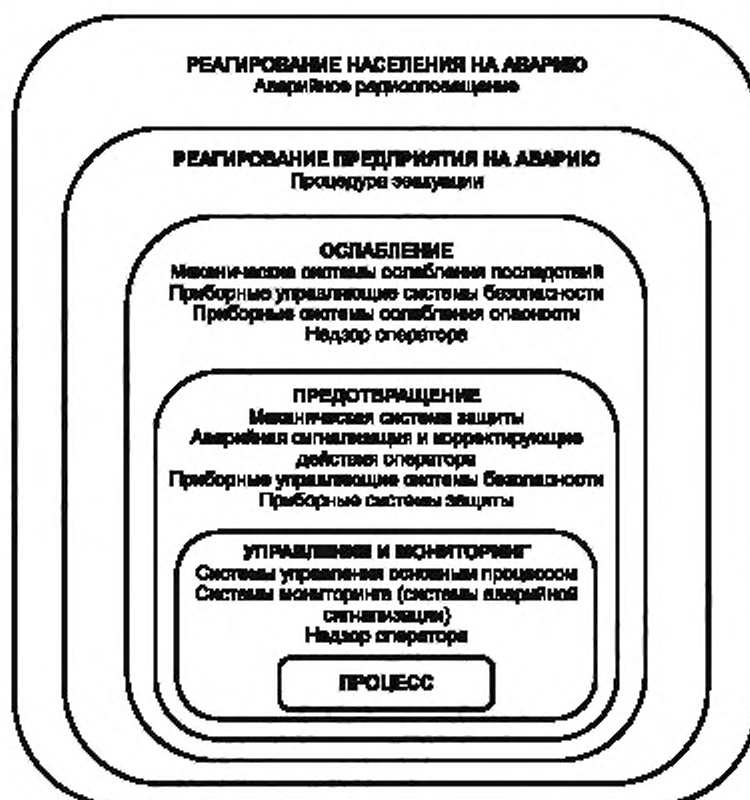
Рисунок 2 — Типовые способы снижения риска, встречающиеся на технологических объектах (модель слоев защиты)
