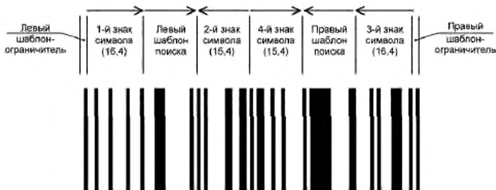
Рисунок 2 — Линейный символ GS1 DataBar Всенаправленный, представляющий номер (01)04412345678909
