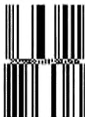
Рисунок 6 — Символ GS1 DataBar Двустрочный Всенаправленный, представляющий номер (01)00034567890125
