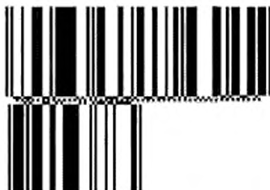
Рисунок 13 — Символ GS1 DataBar Расширенный Многострочный, представляющий номер (01)95012345678903(3103)000123
