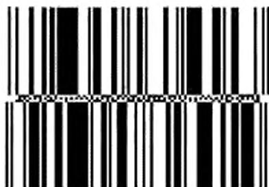
Рисунок 12 — Символ GS1 DataBar Расширенный Многострочный, представляющий номер (01)98898765432106(3202)012345(15)991231
