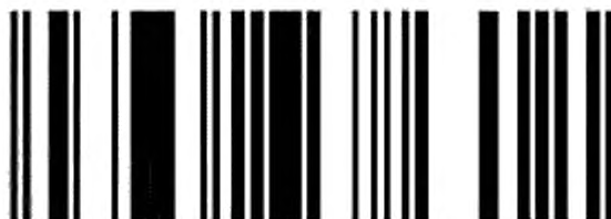
Рисунок 1 — Линейный символ GS1 DataBar Всенаправленный, представляющий номер (01)20012345678909
