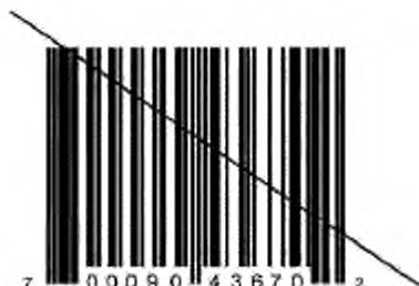
Рисунок Н.5 — Прецедент для символа с префиксом 07 (аналогичен для символа с префиксом 09), когда линия сканирования проходит через верхний край символа
