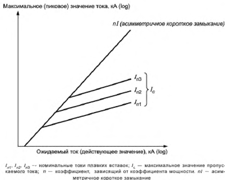
Рисунок 4 — Общее изображение характеристик пропускаемого тока для серии плавких вставок переменного тока (логарифмическая шкала)
