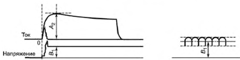
б) Осциллограмма отключения в начале образования дуги после прохождения током максимального значения
