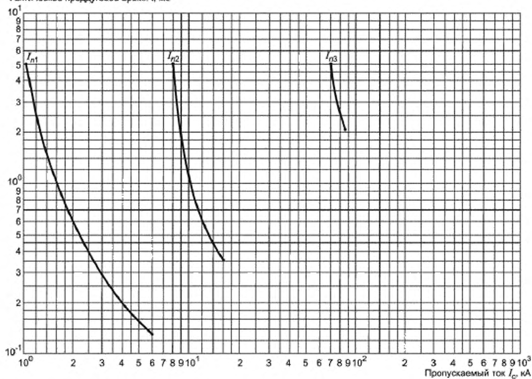
Рисунок С.1 — Зависимость пропускаемого тока от фактического преддугового времени
