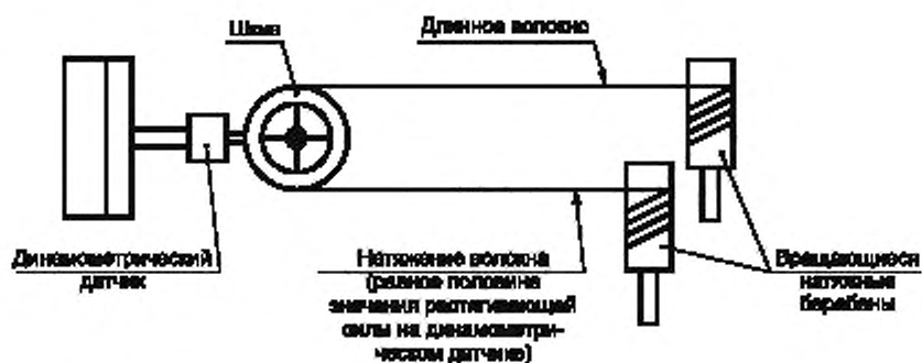
Рисунок А.4 — Испытательное устройство с вращающимися натяжными барабанами для длинных отрезков
