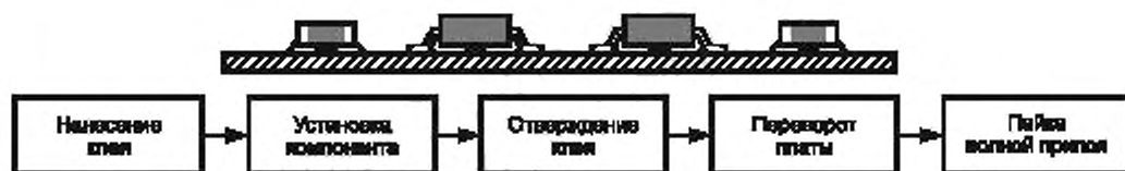
Рисунок 2 — Односторонний печатный узел. Пайка только погружением
