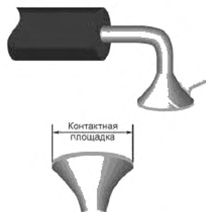
Рисунок 61 — Смачивание припоем: заданное состояние
