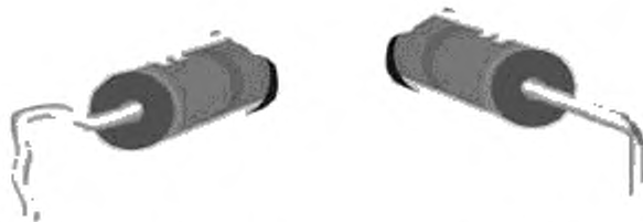
Рисунок 45 — Повреждение осевого вывода компонента: недопустимое состояние
