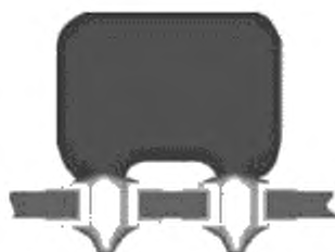
Рисунок 39 — Мениски покрытия, углубленные в отверстия: недопустимое состояние
