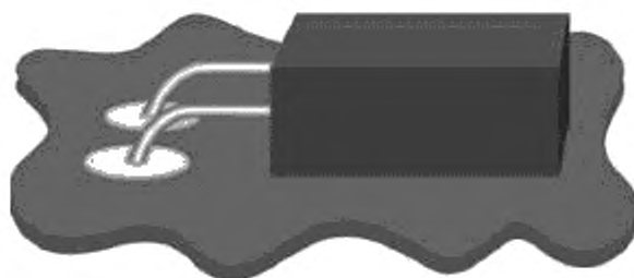
Рисунок 20 — Компонент с радиальными выводами, горизонтальный монтаж: заданное состояние
