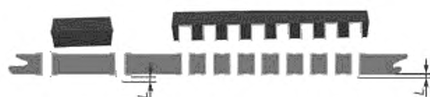
Рисунок 32 — Корпуса DIP: допустимое состояние
