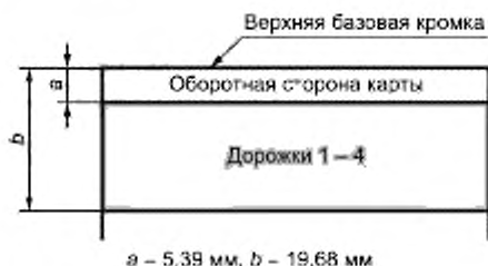
Рисунок 8 — Расположение и высота полосы при четырех дорожках
