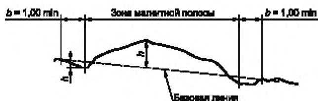
Рисунок 9 — Выпуклый профиль полосы
