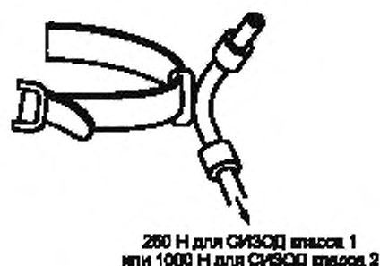
Рисунок 6 — Схема испытания прочности шланга подачи воздуха
