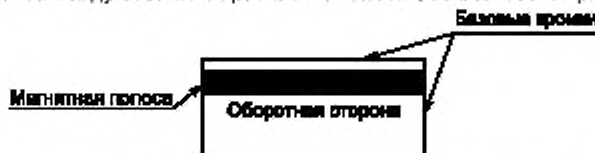
Рисунок 1 — Базовые кромки и боковая полоса
