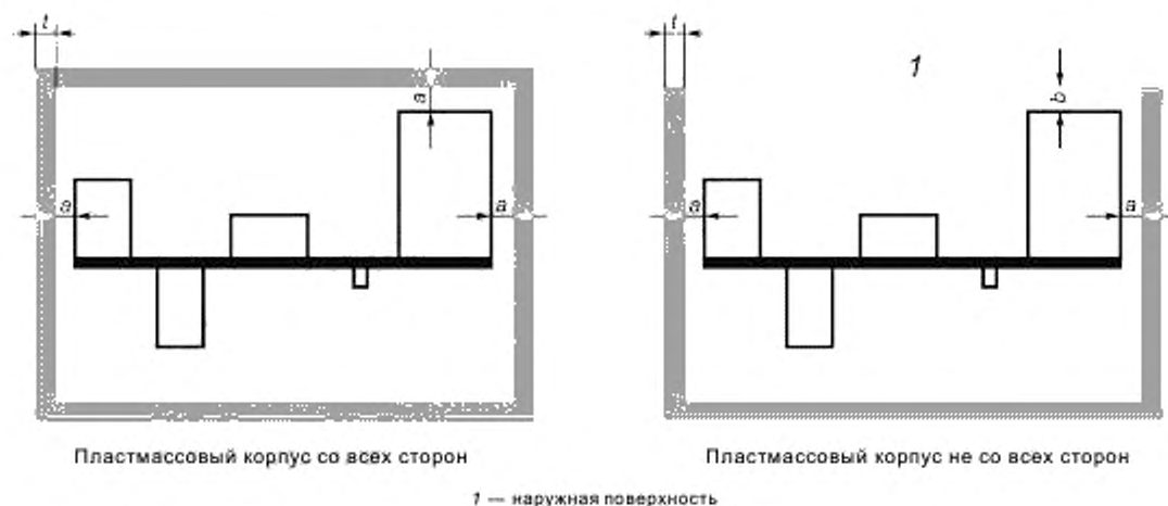
Рисунок 3 — Расстояния между стенкой или наружной поверхностью компаунда и элементами или проводниками
