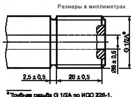
Рисунок 1 — Пример контрольного соединителя для подключения контрольных приборов
