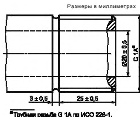
Рисунок 2 — Пример контрольного соединителя для ввода измерителя температуры
