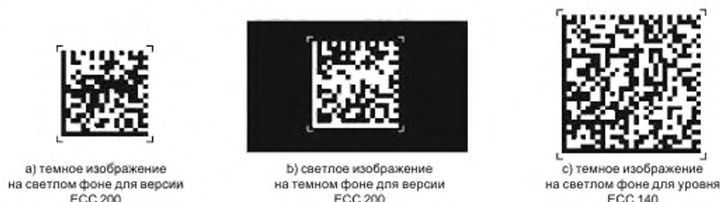
Рисунок 1 — Пример кодирования сообщения «A1B2C3D4E5F6G7H8I9J0K1L2» в символе версии ECC 200 (рисунки a) и b)) и уровня ECC 140 (рисунок c))
