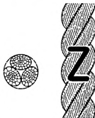
Рисунок 1 — Конфигурация 3-прядного крученого каната (тип А)
