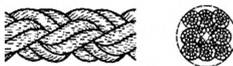
Рисунок 3 — Конфигурация 8-прядного плетеного каната (тип L)
