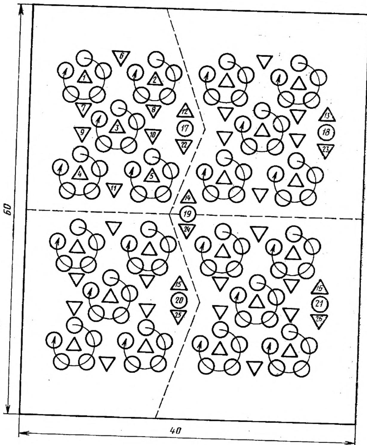
На данной схеме треугольники обозначают отпечатки, наносимые образцовым наконечником, а кружки — поверяемыми наконечниками. Отпечатки поверяемых наконечников расположены по окружности на одинаковом расстоянии от находящегося в центре отпечатка образцового наконечника. Порядок нанесения отпечатков каждым из поверяемых наконечников на всех окружностях должен быть одинаков. Так, например, первый и последний поверяемые наконечники соответствуют началу и концу круговых стрелок.
