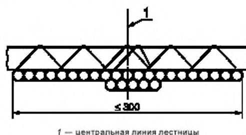
Рисунок 1 — Кабели, закрепленные на передней стороне стандартной лестницы без зазора (комплекты отрезков кабелей находятся в контакте)
