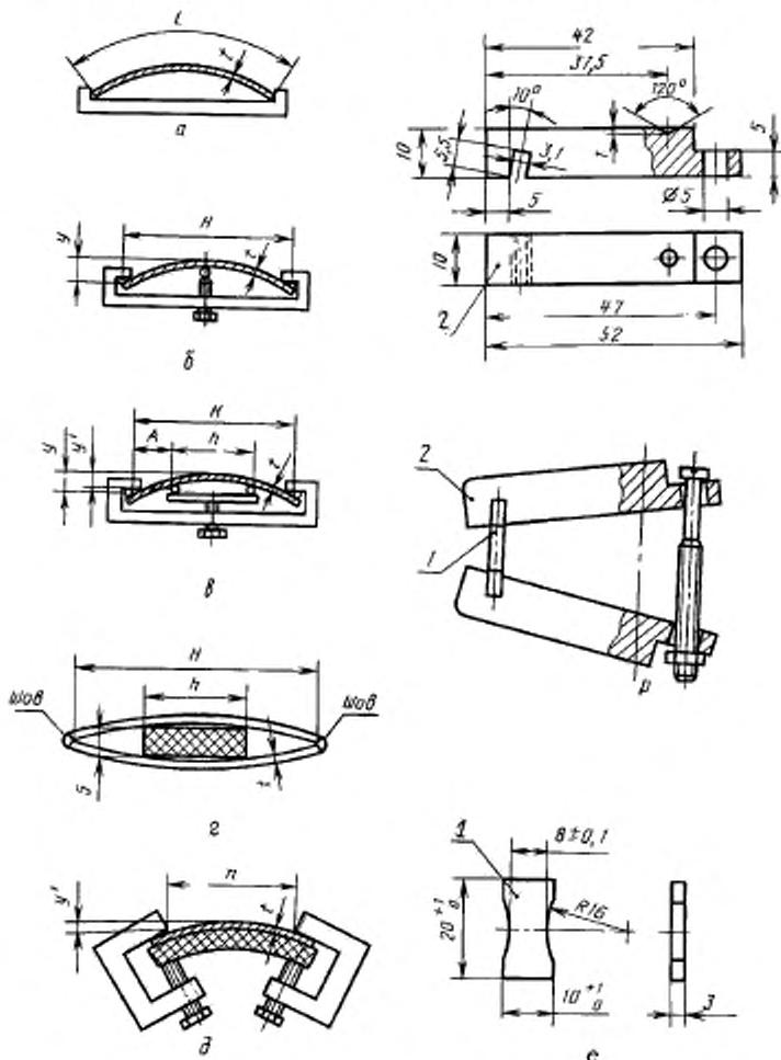
*a* — образец, нагруженный в двух точках; *b* — образец, нагруженный в трех точках; *c* — образец, нагруженный в четырех точках; *d* — образец в виде двойного бруса; *e* — образец, нагруженный с помощью рычага;
