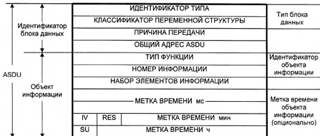
Рисунок 2 — Структура ASDU
