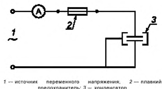
Рисунок 1 — Схема испытания переменным напряжением
