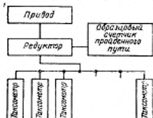
Структурная схема установки для поверки таксометров
